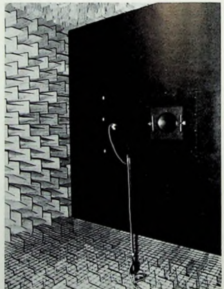
Bild 3 (oben). Anordnung der Keile aus Schallschluckstoffen
