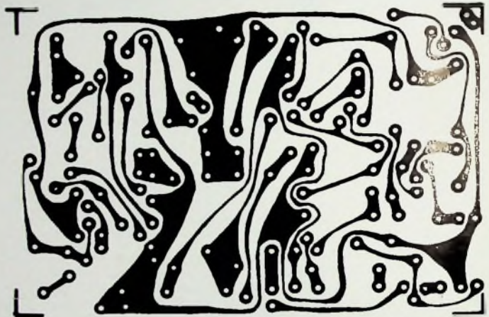
Bild 11. Leiterbahnseite der gedruckten Schaltung (1:1) des Steuergerätes S1
