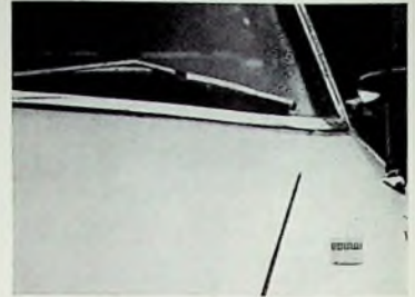
Bild 2. Anordnung des Feuchtefühlers auf der Karosserie ▲
