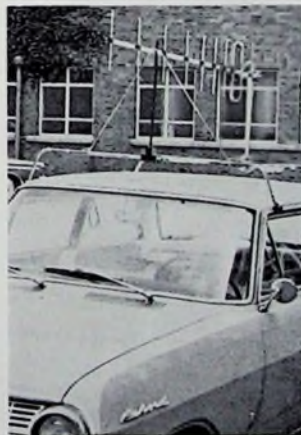
Bild 4. Versuchsfahrzeug mit Richtantenne
