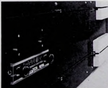
Bild 3 Blick auf die „ARI“-Anlage mit Rundfunkempfänger und Tonbandschleife
