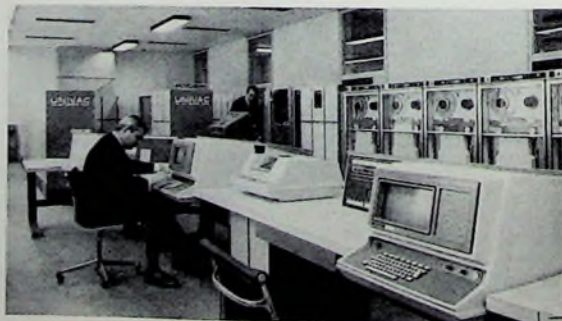
Bild 2. Blick auf das Multiprozessor-System Univac „1108 MP“ des FTZ Darmstadt; im Vordergrund die beiden Konsolen, rechts dahinter die Magnetbandeinheiten, links im Hintergrund die Prozessoren mit den Kernspeichern
