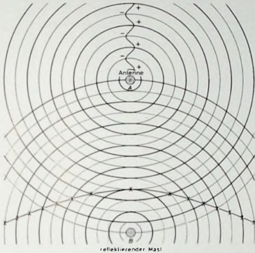
Bild 3. Die Kreise stellen von der Antenne A ausgehende und von einem Reflektor B mit 180° Phasendrehung zurückgeworfene Wellen dar. Die Schnittpunkte der Wellenberge (dick ausgezogen) und der Wellentäler (dünne Linien) zeigen die Orte an, an denen Feldstärke-Einbrüche auftreten (Kreuz im eingezeichneten Weg eines Fahrzeuges)
