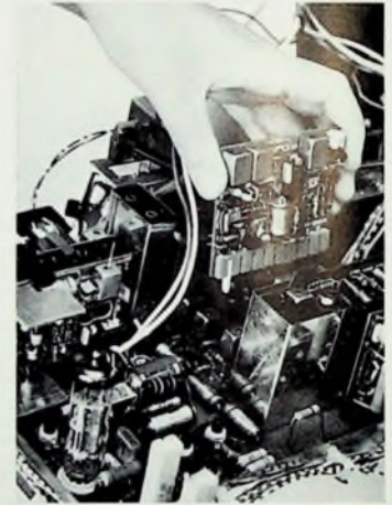
Bild 9. Teilansicht des neuen Körting-Farbfernsehempfänger-Chassis mit steckbaren Bausteinen
