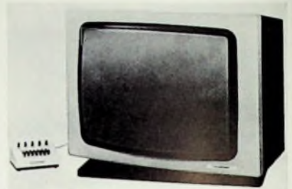
Bild 2: Der Farbfernsehempfänger „Valencia Color“ von Blaupunkt ist ausschließlich über ein separates Steuerpult bedienbar.
