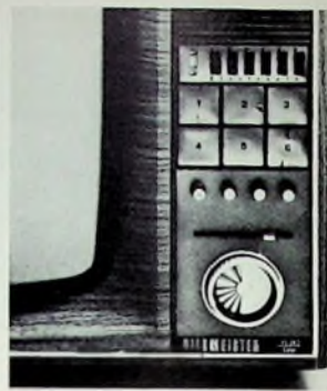
Bild 16 Neuartige Mosaiktastatur im Bedienungsfeld des „Bildmeister FC 240 Color“ von Siemens
