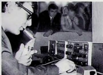
Funkbetrieb an einer Heathkit-Station mit Transceiver „SB102“, Monitorscope und externem VFO
