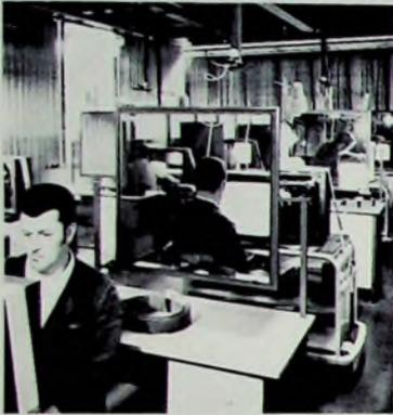
In einer vom eigentlichen Prüffeld abgetrennten Anlage, dem Konvergenzkreis, wird die exakte Konvergenzeinstellung vorgenommen
