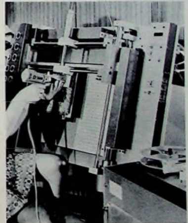
Halbautomatische Verdrahtungsmaschine „TEL 700“ mit Lochstreifenleser (Tranchant Electronique)
