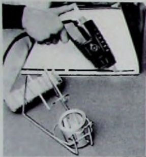
Einsatz der „Thermogrip“-Handpistole „250“ beim Verkleben von Schallplattentaschen
