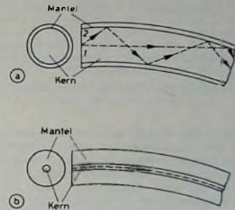
Bild 1. a) Konventionelle Glasfaser, b) dielektrischer Lichtwellenleiter
