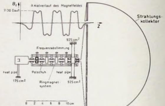
Bild 5. Schematische Gesamtdarstellung eines PPM-fokussierten Klystrons für 12 GHz mit Strahlungskollektor
