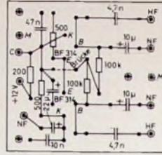
Bild 8. Bestückungsplan für Leiterplatte Mischereinheit (von Leiterseite aus betrachtet)
