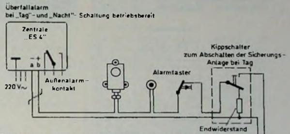
Bild 8. Installationsbeispiel einer Einbruchsicherungsanlage mit Überfallalarm für „Tag“- oder „Nacht“-Schaltung (an Stelle des Endwiderstandes kann auch ein Lichtmelder eingesetzt werden).
