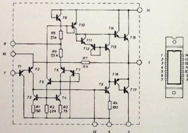
Bild 3. Innenaufbau der integrierten Schaltung TAA 621 und Anschlußblöcke der IS
