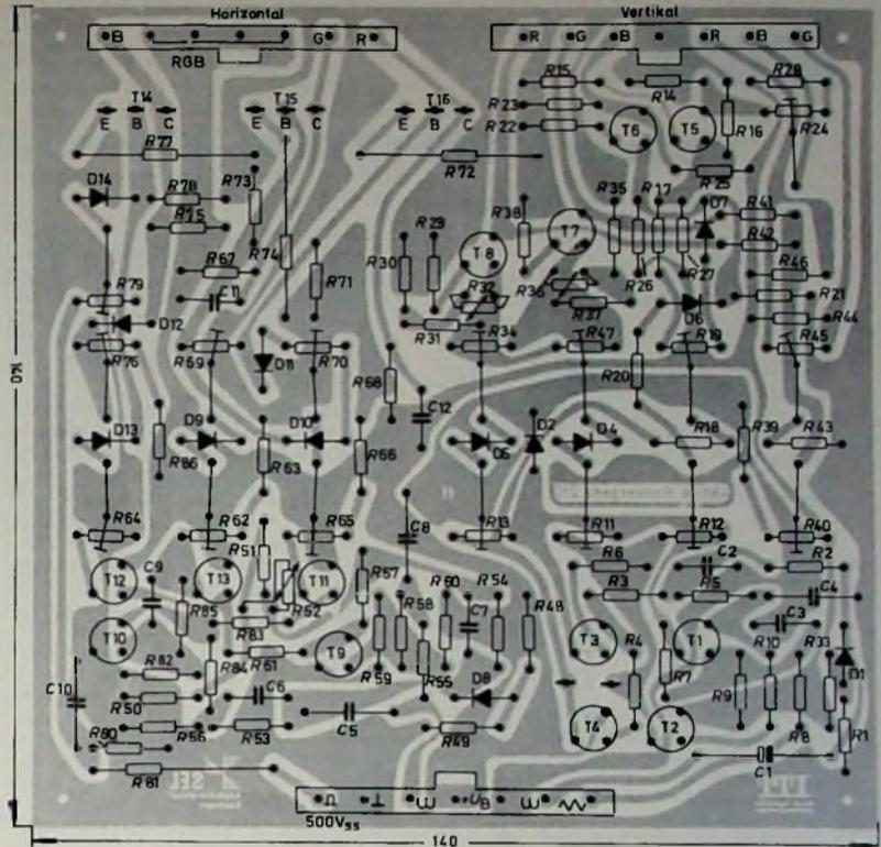
Bild 5. Bestückungsplan der aktiven Konvergenzschaltung; Ansicht von der Bauteilseite
