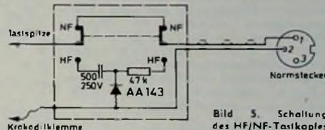
Bild 5. Schaltung des HF/NF-Tastkopfes
