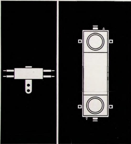
Entstörfilter im Metallrohr mit Befestigungslasche für die Funk-Entstörung von Geräten und Maschinen, die an 2-Phasen Wechselstromnetzen betrieben werden. Querkapazität 0,1  $\mu\text{F}$ ; Schutzkapazität  $2 \times 2500 \text{ pF}$ . Induktivitäten von  $2 \times 1$  bis  $2 \times 6 \text{ mH}$ . Betriebsströme von 1 bis 16 A. Entstörwirkung von 0,1 MHz bis 50 MHz. Der Dämpfungsbereich der Störspannung liegt zwischen 40 und 50 dB.
