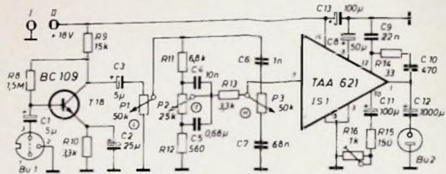
Bild 1. Gesamtschaltbild des Verstärkers mit Klangregelnetzwerk
