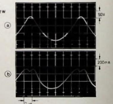
Bild 4. Oszillogramme der Horizontalkonvergenzschaltung: a) Parabelspannung am Punkt 3 der Schaltung, b) Strom durch die Rot-Vertikalkonvergenzspule
