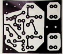
Bild 9. Leiterplatte für Mischereinheit (1:1)
