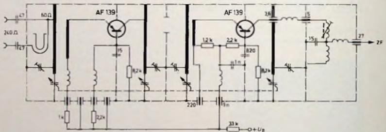
Bild 6 UHF-Tuner mit Drehkondensatorabstimmung und abgestimmtem Vorkreis
