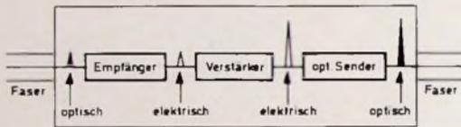
Bild 2 Repeaterstation für ein Nachrichtenübertragungssystem mit dielektrischem Lichtwellenleiter
