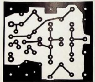
Bild 13. Leiterplatte für Tongenerator (1:1)
