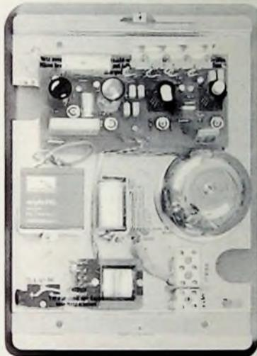
Bild 7. Labormuster einer Einbruchsicherungszentrale „ES 4“. Gehäuse durchsichtig dargestellt (Werkaufnahme: A. Zettler GmbH, München).
