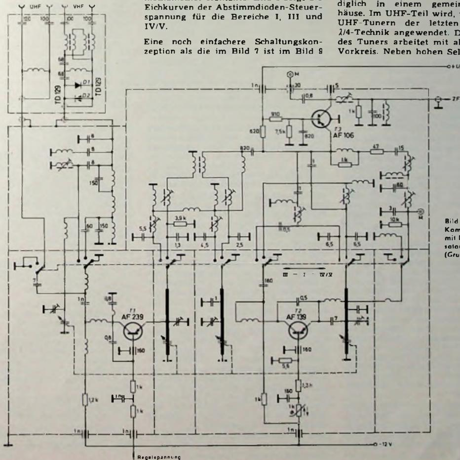
Bild 9. Kombinationstuner mit Drehkondensatorabstimmung (Grundig)
