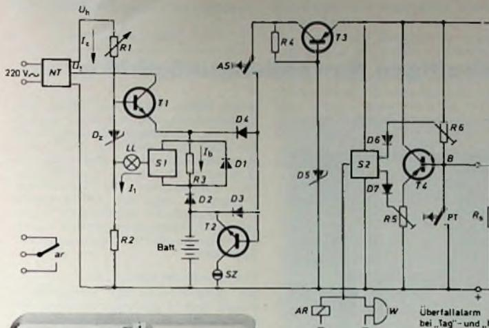
Bild 6 (oben). Grundschaltung einer Einbruchsicherungsanlage „ES 4“.
