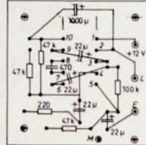
Bild 10 (oben). Bestückungsplan für Leiterplatte NF-Verstärker (von Leiterseite aus betrachtet)
