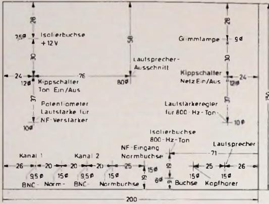
Bild 7 (oben). Bohrzeichnung für die Frontplatte
