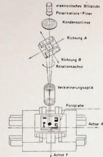
Bild 1. Schematische Darstellung der Hauptelemente der Fotokompositionsmaschine
