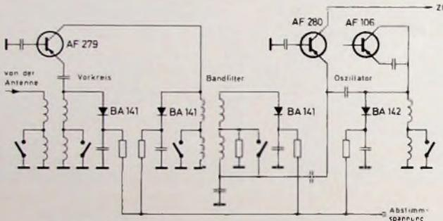
Bild 5 Prinzipschaltung eines VHF-Tuners mit abgestimmtem Vorkreis (Grundig)
