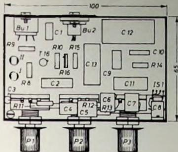
Bild 4. Bauteilanzordnung auf der Platine
