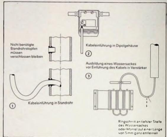
Bilder 1—3. Kabel Einführung in Standrohre und Dipolgehäuse sowie Verwendung eines Wassersackes mit Ringschnitt
