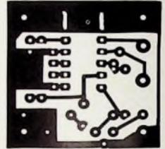
Bild 11. Leiterplatte für NF-Verstärker (1:1)
