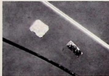
Bild 3 Die Grundkomponenten des von AEG-Telefunken entwickelten optischen Nachrichtenübertragungssystems sind kaum größer als ein Menschenhaar dick ist. Sender (dunkler, rechteckiger Gegenstand), Empfänger (heller, quadratischer Gegenstand) und Glasfaser (heller Strich) im Vergleich zu einem Menschenhaar (links unten, dunkler Strich)
