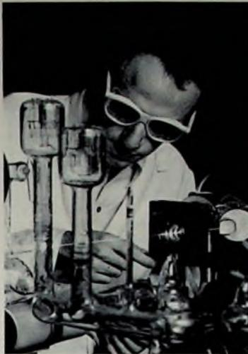
Bild 5. Als Lichtquelle für die optische Datenzeichnung wird ein Laser benutzt, dessen grüne Ausgangsstrahlung durch optische Frequenzverdopplung in ultraviolettes Licht umgesetzt wird.
