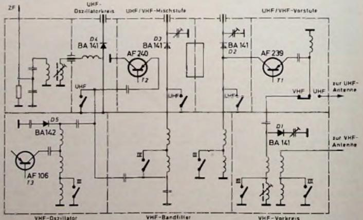
Bild 7 Schaltung eines Kombinationstuners von Grundig
