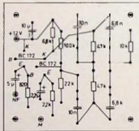
Bild 12. Bestückungsplan für Leiterplatte Tongenerator (von Leiterseite aus betrachtet)
