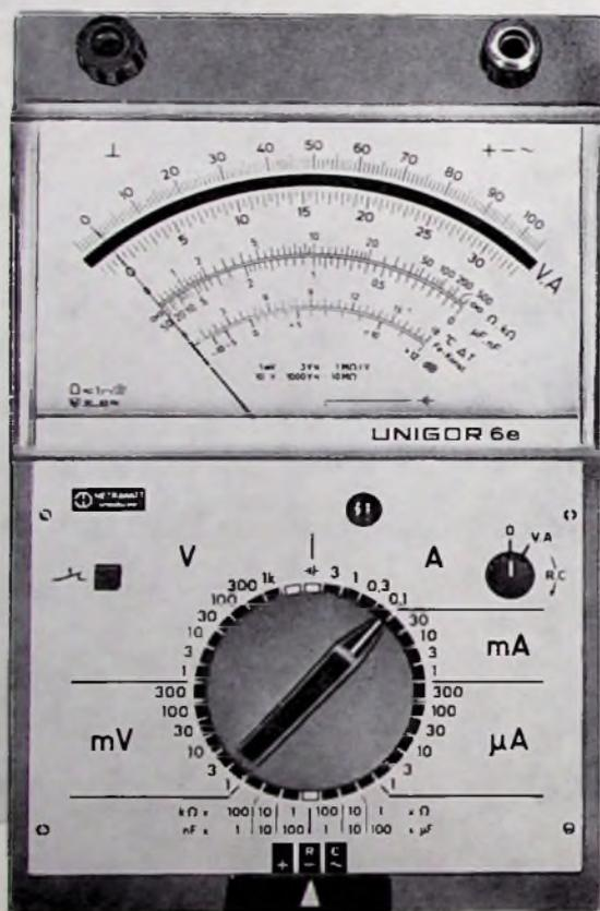
Der hohe Eingangswiderstand von  $1\text{ M}\Omega/V$  bei Gleich- und Wechselstrom ermöglicht einen universellen Einsatz des neuen Vielfachmessers.
