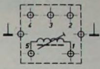
Bild 8. Schaltung der Kleinstspulen der Reihe „7“ von Neosid
