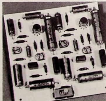
Bild 3. Der betriebsfertige Stereo-Entzerrer-Vorverstärker
