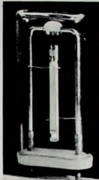
Bild 2. Schwingungen eines Quarz-Biegeschwingers
