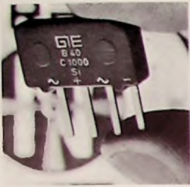
Bild 4 Eine Gleichrichterbrücke zum Einsetzen in Leiterplatten von General Instrument ist nicht viel größer als ein Daumennagel
