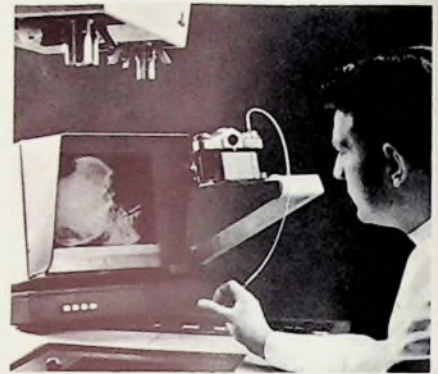
Bild 3. Elektronisches Subtraktionsgerät; Kamerahalterung am Sighgerät
