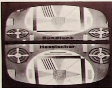
Bild 1. Beispiel für die Dokumentation von Bildfehlern (Fehler in der vertikalen Ablenkung). Aufnahme auf Isopan 155
