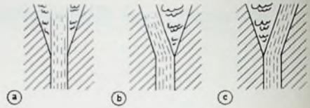
Bild 4. Schema des auf die Prandtl-Entdeckung aufgebauten Moore-Klein-Diffusors
