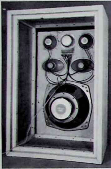
Bild 5 Ein Blick in das Gehäuse (oben: 2 Hochtonlautsprecher mit Frequenzweiche, Mitte: 2 Mittel-Hochtonlautsprecher, unten: Tieftonlautsprecher)
