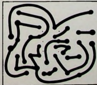
Bild 3. Printplatte im Maßstab 1:1
