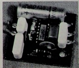
Bild 4. Bestückung der Platine, von der Bestückungsseite her gesehen
