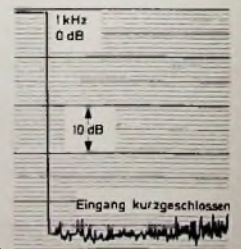
Bild 9. Maximale Ausregelzeit der Aussteuerungsautomatik nach Pegelrückgang von Vollaussteuerung (0 dB) auf etwa -40 dB
