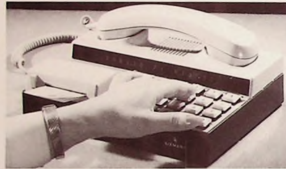
Datenfernsprecher von Siemens, dessen Gestaltung ein Ergebnis moderner Human-Factor-Untersuchungen ist.
