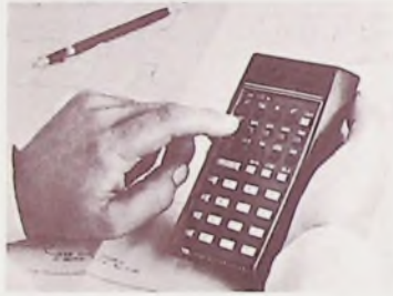
Bild 1: Elektronischer Taschenrechner „HP-35“ von Hewlett-Packard zur Verarbeitung von Zahlen zwischen 10^{-99} und 9,999999999 \cdot 10^{99}
