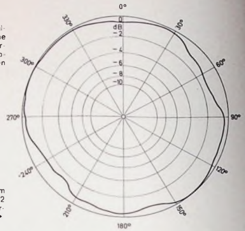
Bild 3. Horizontaldiagramm einer Antenne nach Bild 2 mit 12 Drehkreuz-Viererguppen bei 618 MHz
