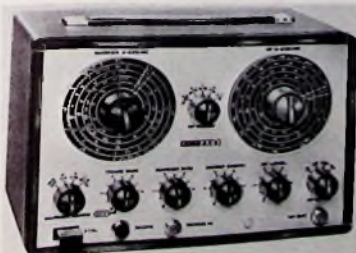
Bild 1. Wobbelsender „369“ mit eingehautem Eichmarkengeber
