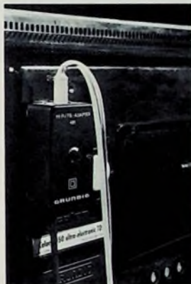
Bild 2 Nachgerüsteter Adapter an der Rückwand des Farbfernsehgerätes
