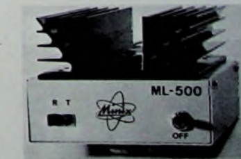
2-m-Endstufe „ML 500“ mit Kühlrippen für den Endstufen-Transistor ( Richter )
