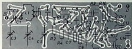
Bild 3. Anordnung der Bauelemente auf der Platine
