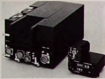
Bild 6 Vom TACAN-SETAC-Bordgerät ge- lieferte Signale ▶
