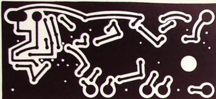
Bild 4. Printplatte des Transistor-Einkreisers
