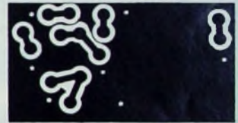
Bild 4. Gedruckte Schaltung der Spulenplatte (Maßstab 1:1)
