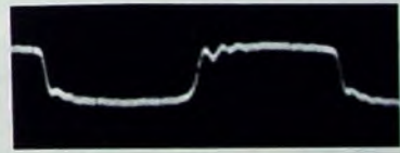
Bild 5 Oszillogramm der Ausgangsspannung beim Abtasten einer Rechteckschwingung mit 1 p Auflagekraft (Abschlußwiderstand 47 kOhm)
