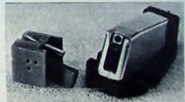
Bild 4 Systemaufbau und auswechselbarer Nadelträgereinschub
