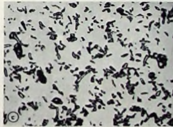
Bild 1. Mikroaufnahmen der Lotpulver; a) FSS-Wert 1,18 µm, b) FSS-Wert 12,6 µm, c) FSS-Wert 14 µm
