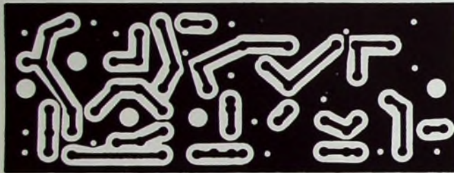
Bild 4 (oben). Platine des Senderteils (Maßstab 1:1)
