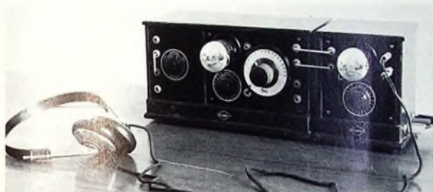
Bild 1 Einröhren-Audion „RE 1“ und NF-Verstärker „NF 1“ von Sachsenwerk (Baujahr 1925/26)
