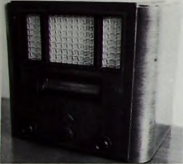
Bild 4. Vierröhren-Dreikreis-Geradeempfänger „47 WL“ von Siemens mit eingebautem Lautsprecher und Länderbandskala (Bauj. 1933)
