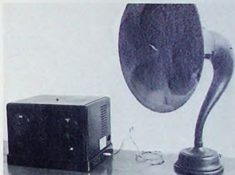
Bild 2 Dreiröhren-Einkreis-Geradeempfänger „1304 W“ von Tefag für Wechselstrom-Netzanschluß, mit Trichter-Lautsprecher (Baujahr 1927)
