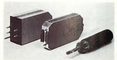
Bild 5. Regenerativverstärker für die Systeme „PCM 120“ (links) und „PCM 30“ (Mitte) sowie bündelgeschirmtes PCM-Kabel (rechts)
