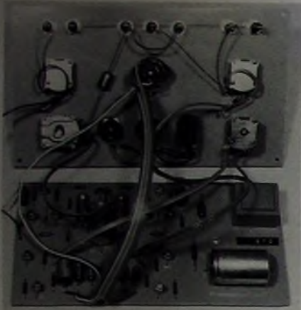
Bild 8 Mit der Printplatte über flexible Leitungen verbundene Frontplatte
