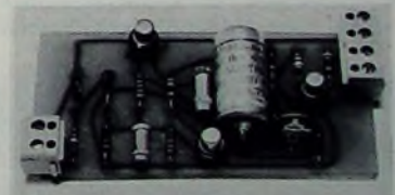
Bild 3. Bestückungs- und Verdrahtungsplan nach Bild 2 (von der Bestückungsseite her gesehen)
