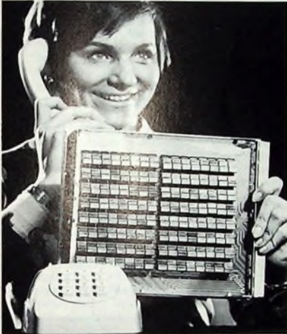
Bild 1. Baugruppe eines „EWS 1“-Koppelnetzes mit 128 Koppelpunkten mit je zwei Schutzgaskontakten im Metallgehäuse
