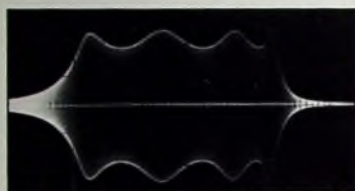
Bild 16. Oszillogramm der Durchlaßkurve nach Bild 15
