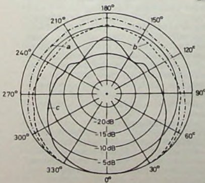
Bild 3 Richtdiagramm des Kugelmikrofons „SM 61“ bei 2,5 (a), 4 (b) und 10 kHz (c)
