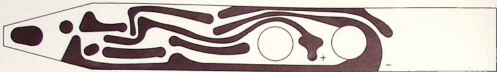
Bild 3. Printplatte des L-H-Anzeigers für die Schaltung nach Bild 1
