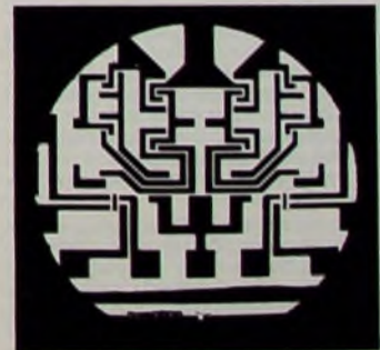
Bild 9. Holografisch projiziertes reelles Bild einer Atzmaske für eine integrierte Schaltung
