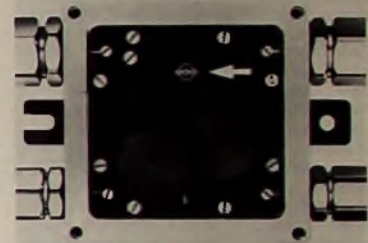
Bild 5. Passiver Abzweiger (geöffnet) in Richtkopplertechnik für Kabelfernsehanlagen; universeller Einsatz ist durch herausnehmbare Steckbausteine gegeben
