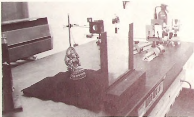
Bild 4 Wiedergabe eines Hologramms – ebenfalls mit einem Laser gleicher Frequenz – wie bei der Aufnahme
