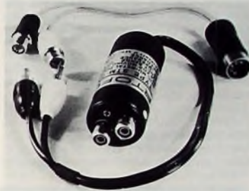
Bild 2 Übertrager „STM-72“ zum Quadro-Tonabnehmer „SL15Q“ mit Übergangskabel Cynch-DIN-Buchse
