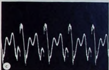
Bild 7. Trackability-Test mit dem Testsignal 1 + 1,5 kHz: a) 15 cm/s (von beiden Systemen gleich gut abgetastet), b) „M15E-Super“ bei 25 cm/s und 1 p, c) „SL15Q“ bei 25 cm/s und 1,5 p (Lautwerk Dual „701“)
