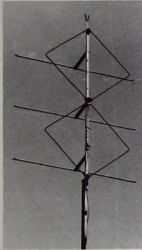
Bild 1 Hybrid-Doppelquad-Antenne für 144 ... 146 MHz
