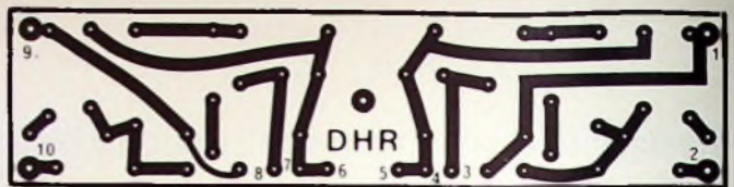
Bild 3 (oben) Printplatte für den Doppelhelligkeitsregler (Maßstab 1 : 2)
