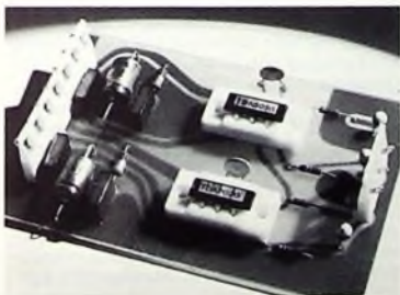
Bild 1. 2 \times 15 -W-Stereo-Verstärker, der mit zwei TDA 2020 bestückt ist (SGS-Ates)
