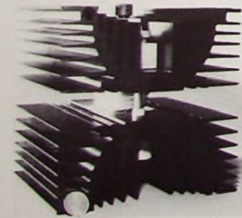
Bild 4 Kühlvorrichtung für Thyristor im Flachgehäuse (Alsthom-CGE)
