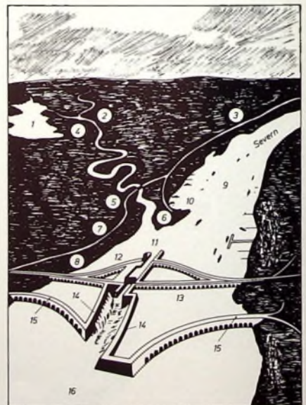
Bild 3. Erstes englisches Projekt zu einem Gezeitenkraftwerk (Zweibeckenanlage) am Severnfluß; Gezeitendifferenz etwa 13 m, Leistungsgröße 10^7 kW (Zeichnung H. Günther)
