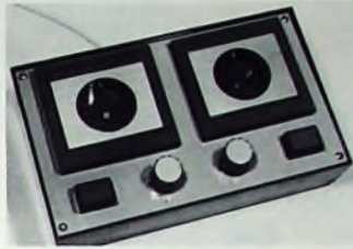
Bild 1. Ansicht des Doppelhelligkeitsreglers „Duolux“ im pultförmigen Teko-Gehäuse
