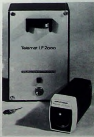
Sender (im Vordergrund) und Empfänger der Lichtfernsteuerung „LF 2000“
