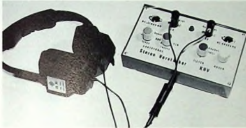
Bild 1. Stereo-Kopfhörerverstärker im pullförmigen Teko-Gehäuse mit angegeschlossenem Stereo-Kopfhörer
