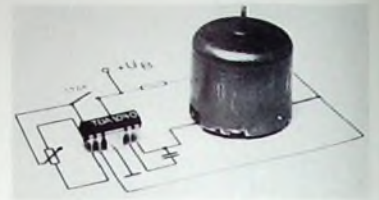
Integrierter Motor-Drehzahlregler TDA 1040 (Thomson-CSF)
