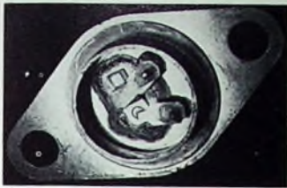
Aufbau der Thyristor-Dioden-Kombination BT 128 (Valvo)
