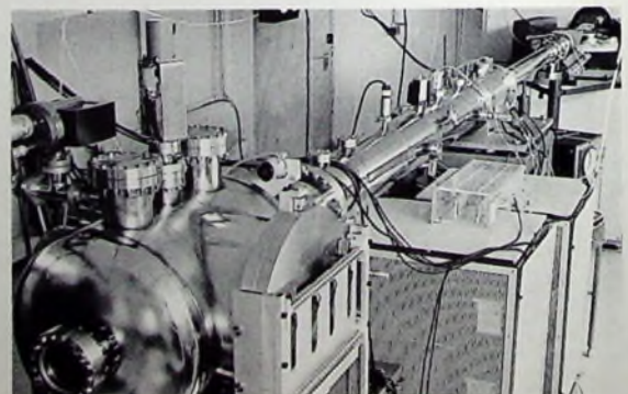
Bild 6. Teilansicht der Ionenimplantationsanlage mit Beschießungskammer (vorn links), Beschleunigungsrohr und Ablenkeinheit
