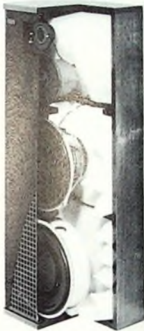
Bild 1. Innenaufbau des Abhörlautsprechers „Ditton 66“. Von unten nach oben: parasitärer Tieftonstrahler 12"-Tieftonsystem „UL 12“, Kalotten-Mitteltontonsystem „MD 500“ und Kalotten-Hochtonsystem „HF 2000“
