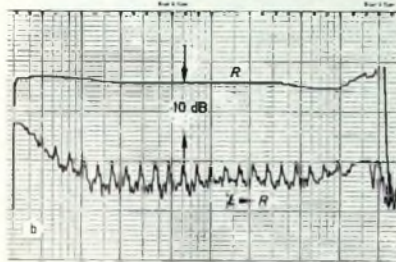
Bild 7 Frequenzgang des Übersprechens: a) vom linken zum rechten Kanal, b) vom rechten zum linken Kanal (Meßschallplatte DGG 1 099 112, Tonarmauflagekraft 15 p, R_L = 47 kOhm, Laufwerk Dual „701“)
