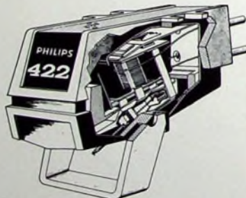
Bild 1 Schnittbild des Hi-Fi-Quadro-Tonabnehmersystems „Super M 422“
