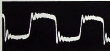
Bild 5. Einschwingverhalten des „PU 4E“ beim Abtasten einer 1-kHz-Rechteckschwingung (Tonarmauflegekraft 0,75 p, R_1 = 47 kOhm)
