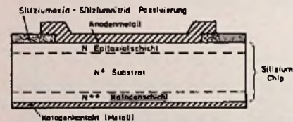
Bild 5. Schematischer Schnitt durch einen Schottky-Gleichrichter
