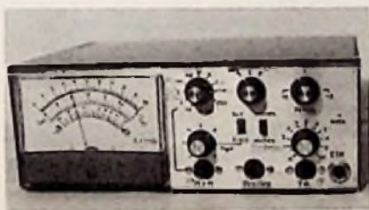
Bild 1. Ansicht des NF-Millivoltmeters mit Klirrfaktor-Meßzusatz
