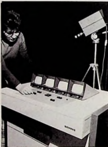
Dreikanal-Bildregie-Mischpult von Siemens für die Umschaltung, Trickmischung und Überblendung der Bildsignale von Schwarz-Weiß-Fernsehkameras. Hintergrund: Schwarz-Weiß-Fernsehkameras „K7“
