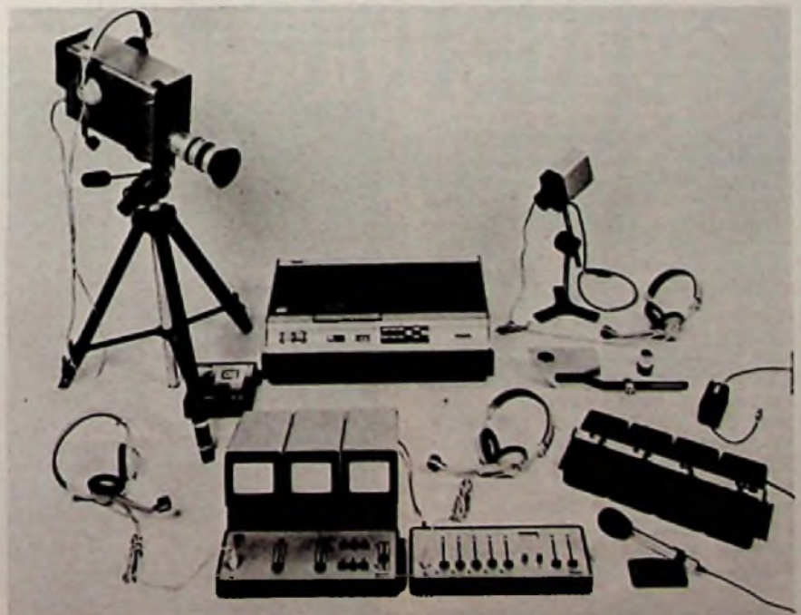
Fernseh-Mini-Studio „LDH 8310“. Von links nach rechts: Fernsehkamera „LDH 225“, VCR-Gerät, Bildregie und Tonregie, Batteriesatz
