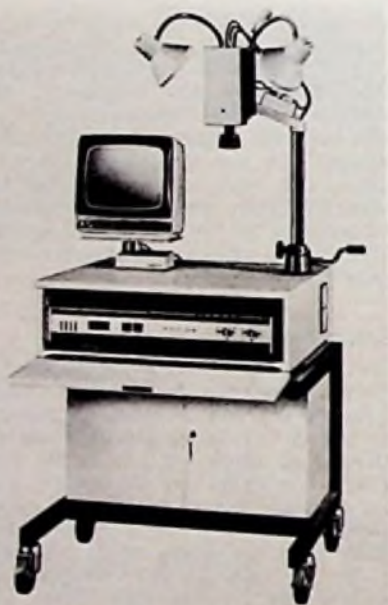
AV-Wagen „Video“ von Grundig mit einer Kamera auf höherverstellbarem, schwenk- und neigbarem Kugelstativ, einem drehbaren Monitor, Bedlengerät und Beleuchtungseinrichtung
