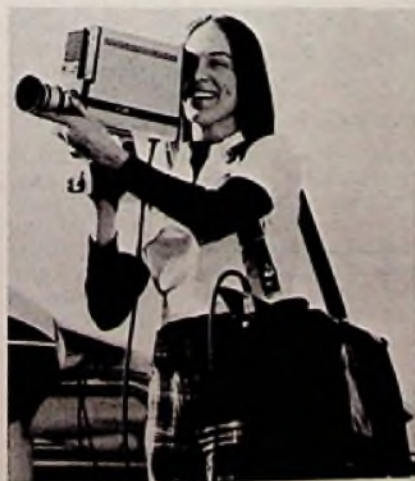
Tragbare Farbfilmkamera und 1/2"-Farbrecorder der Japan Victor Company im Vertrieb von Bell & Howell
