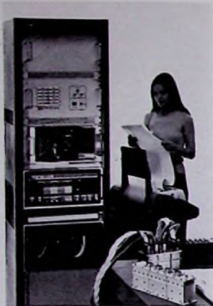
Bild 3. Diese rechnergesteuerte Testeinrichtung für Satellitengeräte druckt die Ergebnisse aus und ermöglicht es, Fehler leichter als bisher zu entdecken und einzukreisen
