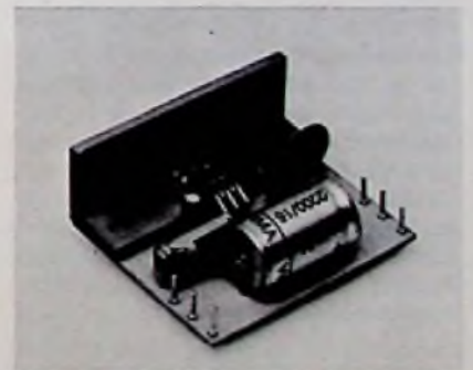
Bild 5. Der 7-W-Verstärker mit der L 140 von SGS-Ates kommt mit sehr wenigen zusätzlichen Bauelementen aus
