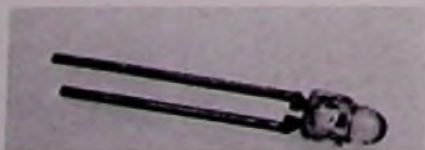
Bild 13. Phototransistor BPW 22 von RTC in durchsichtigem Kunstharzgehäuse
