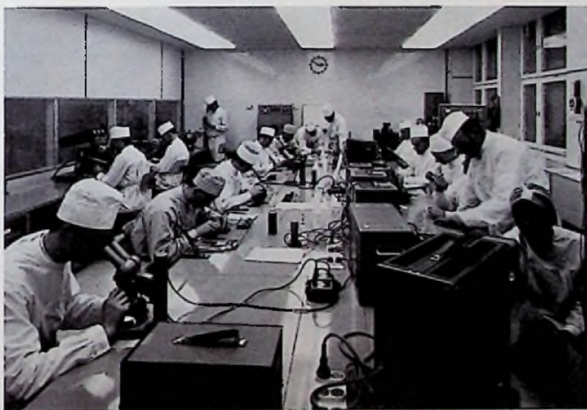
▲ Bild 1. „Cleanroom“ für Mikro-Elektronik bei SEL (Klasse 10 000 nach Federal Standard 209)
