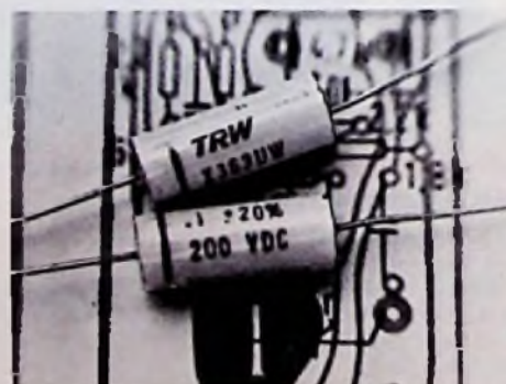
Kondensatoren aus metallisiertem Polypropylen (Foto: TRW)
