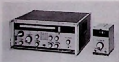
Bild 1. Allwellenempfänger „E 410“ für den Frequenzbereich 70 kHz ... 30 MHz, bestückt mit 100-Hz-Raster-Einschub; rechts daneben: 100-kHz-Interpolator-Einschub
