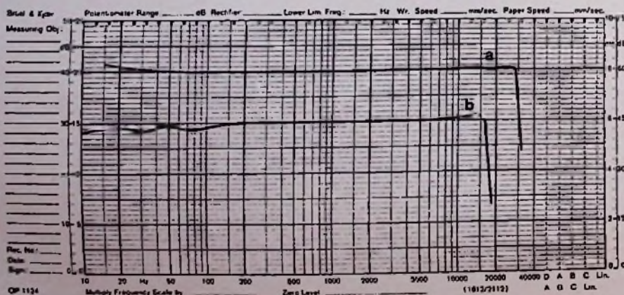
Bild 4. Typischer Frequenzgang eines Plattenspielers (a) und eines Cassetten-Decks (b)
