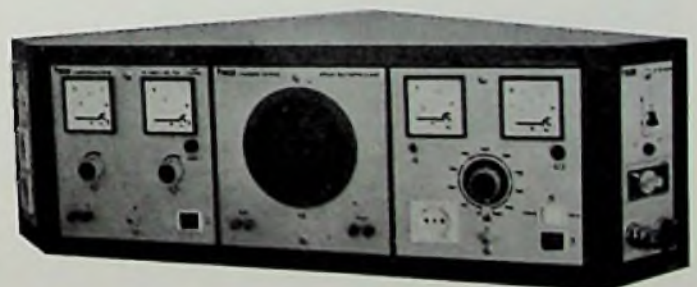
hera-Eckaufbau Typ FR 75/1 mit 3 Baueinheiten FR W/1, FR 30/1 und Lautsprecher-Baueinheit, Stromversorgungs- und Steckdosenbauteile
