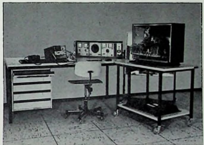
Die Abbildung zeigt einen Meß- und Prüfplatz mit hera-Arbeits- u. Labor-tisch LAT 2180, einen fahrbaren Unterschrank USS 2000 F, einen fahrbaren Spiegel und einen hera-Eckaufbau FR 75/1
