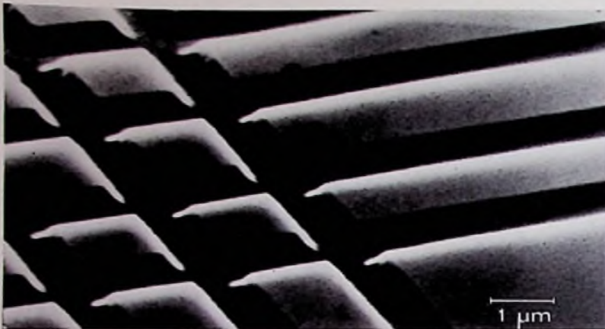
Bild 6. Rastermikroskopische Aufnahme eines direkt durch den Elektronenstrahl belichteten und geätzten Wafers
