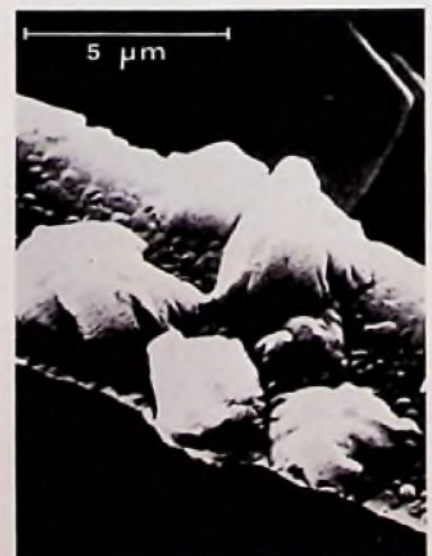
Bild 2. Schäden an einer Aluminium-Leiterbahn durch Materialtransport infolge hoher Stromdichte
