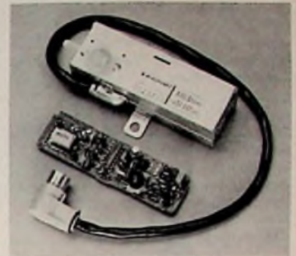
Bild 6. ASU-Schaltung zum Nachrüsten durch Anstecken
