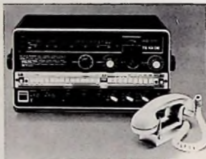
Bild 8. SSB-Seefunkanlage Ro 1150 (TEKADE)
