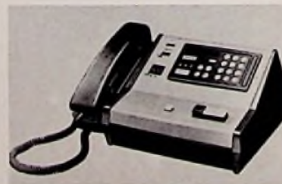
Bild 11. Zugpostfunkanlage öbL-Netz B für Selbstwahl in Zügen (TEKADE)
