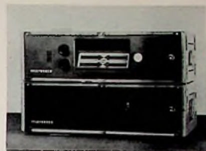
Bild 14. Anrückmelder zur Rottenwarnung (AEG-Telefunken)
