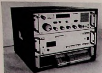
Bild 15. Programmierbare Frequenzband-Überwachungsanlage AFR 1500 (AEG-Telefunken)
