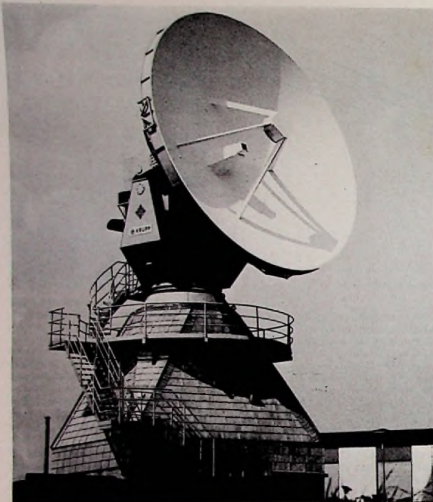
Bild 8. Die Versuchs-Erdefunkstelle Leeheim der Bundespost war die erste von AEG-Telefunken gebaute Bodenstation im 14/11-GHz-Bereich
