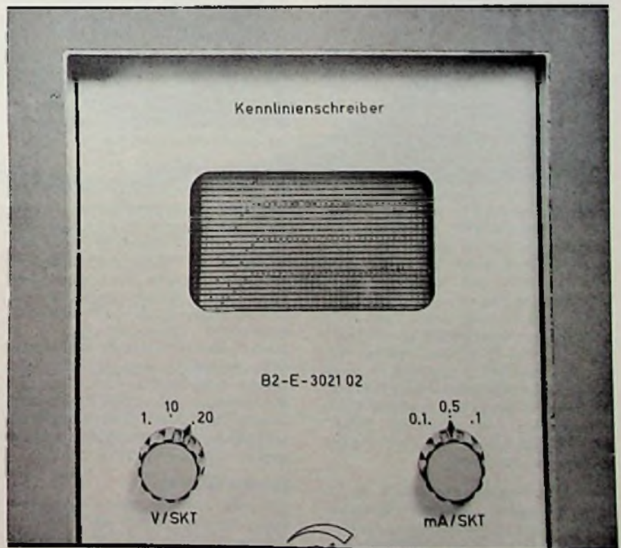
Bild 3. Der aus 1250 Dioden zusammengesetzte Kleinbildschirm (5 cm x 10 cm) kann für die Darstellung einfacher Funktionen die Aufgaben einer Oszilloskop-röhre übernehmen.
