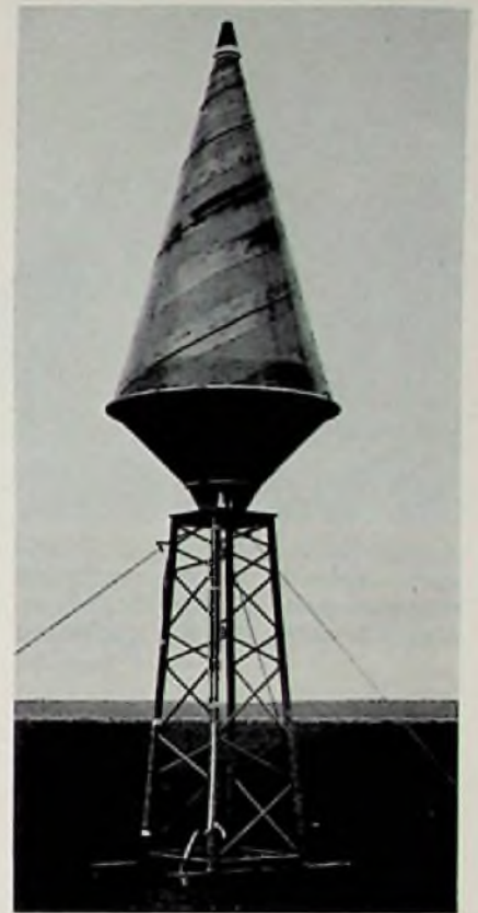
Bild 7. Konische Spiralanterie für Rundempfang
