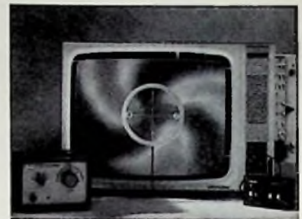
Farbtester FT 110 mit dem Pal-Service-Generator PM 5507 (links), der das Trägersignal liefert, während der Anwendung
