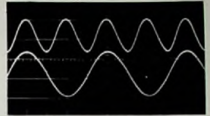
Bild 2. Abgleich des Multiplikators als Quadrierer. An der oberen Kurve sieht man deutlich die ungleichen positiven und negativen Anteile.
