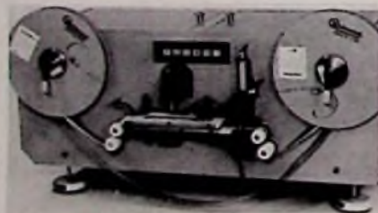
Testet gegurtete Bauelemente: das Prüfgerät 640 von Lorlin
