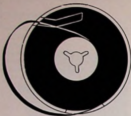
Bild 2. Prinzip der Einloch-Endlos-Cassette, z. B. des Stereo-8-Systems
