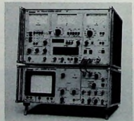
SSB-Analyser mit dem Funkgeräte-Meßplatz „Stabilock“
