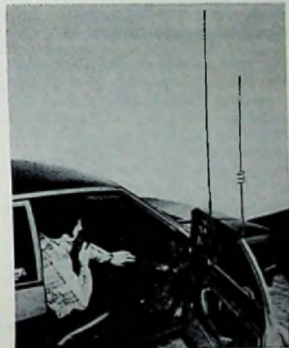
Fensterantennen für das 2-m- und 70-cm-Band von Hirschmann während des Funkverkehrs
