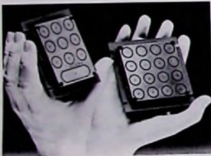
Bild 8. Elektronische, nach dem Prinzip der kapazitiven Kopplung arbeitende Tastkontakt-Tastaturen von Pye Electro-Devices Ltd.
