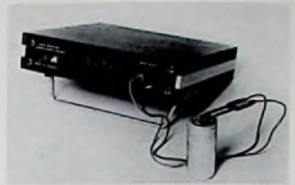
Bild 6. Kapazitätsmeßgerät ESP300A für den Bereich 1 pF bis 2000 µF (Toleranz \pm 0,5\% ) von Electronic Services & Products Ltd.
