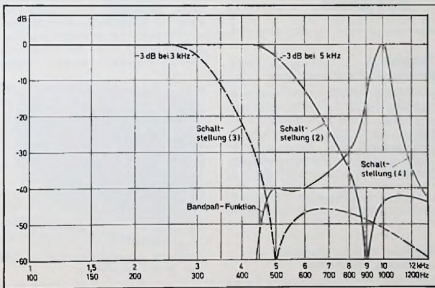
Bild 12. Filterkurven der Schaltung von Bild 11. Die Sperrstellen entsprechen den durch den Trägerabstand (5 kHz bei KW, 9 kHz bei MW) gegebenen Interferenztönen
