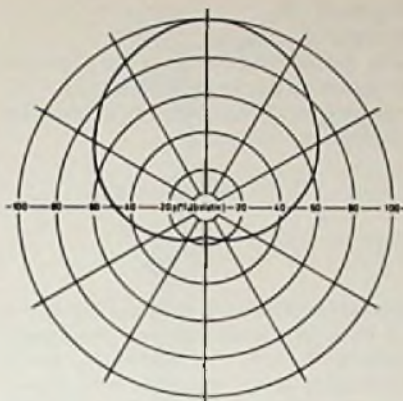
Bild 5. Horizontal-Diagramm eines Tonstrahlers mit nierenförmiger Abstrahlcharakteristik
