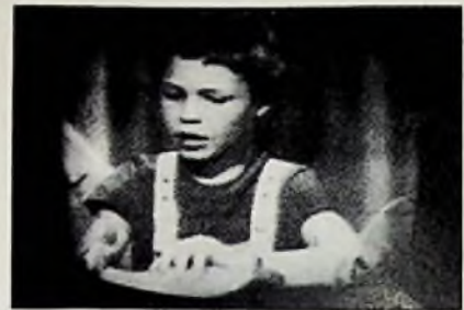
Bild 6.05. Fernsehbild mit Moiré-Störungen
