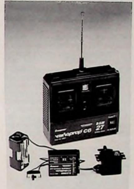
**Bild 2.** Vorzugsweise für Auto- oder Schiffsmodelle gedacht ist die kompakte Sechskanal-Fernlenkanlage „Varioprop C 6 SSM 27“ in AM-Technik (Grundig)
