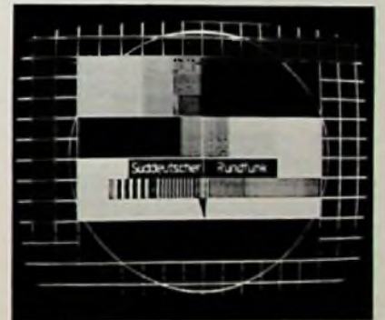
Bild 9.05. Störung durch Kreuzmodulation (Scheibenwischereffekt)
