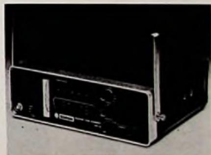
Rundfunk-Pegelmeßgerät RPM 290 (Hirschmann)
