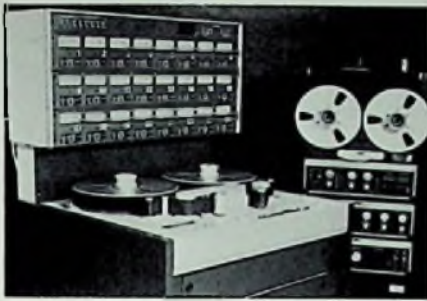
Bild 2. Beinahe unfair wirkt der reine Größenvergleich zwischen einer modernen Mehrkanal-Studiomaschine im Vordergrund und einem hochwertigen Amateurgerät im Hintergrund
