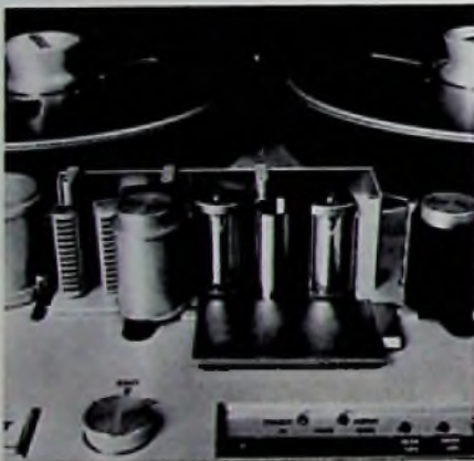
Bild 7. Kopfräger einer Studiomaschine. Die wichtige Bedingung höchster Stabilität wird durch massive Stahlgußträger sichergestellt. Nur so ist die geforderte Genauigkeit und Langzeitstabilität zu erreichen
