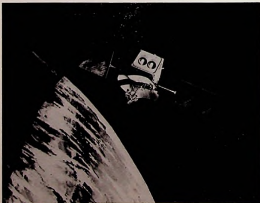
Bild 1. Zeichnung des SATCOM III mit voll entfaltenen Solargeneratoren und Antennen für horizontale und vertikale Polarisation (Bilder: RCA)
