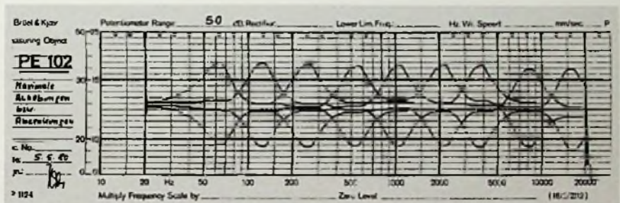
Bild 5. Maximale Pegelanhebung und -absenkung in neun Oktavbändern. Mittenfrequenzen: 63 Hz, 125 Hz, 250 Hz, 500 Hz, 1 kHz, 2 kHz, 4 kHz, 8 kHz und 16 kHz
